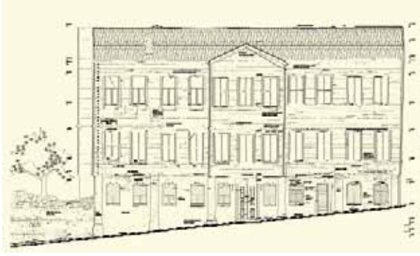
Şekil 28. Kuzeydoğu Cephesi Rölöve Çizimi
