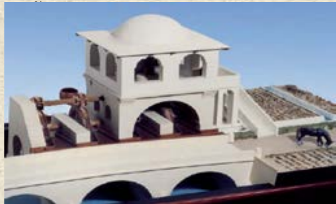
Hayvan kuvvetinden enerjisini alan ve günümüzde; Mısır, Hindistan ve İspanya'da kullanılan su dolabı
