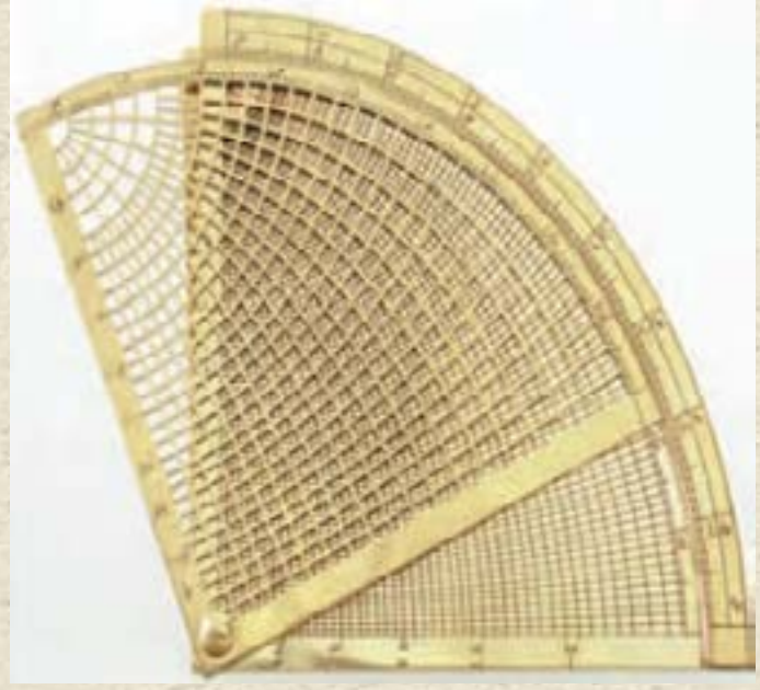
Küresel astronomi hesaplamalarını bir alet yardımıyla yapabilmek için Cemâleddin Abdullâh b. Halil el-Mâridini (ö.809/1406) tarafından yapılan şekkaziye
