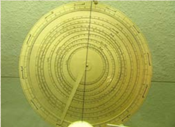
Uluğ Bey'in hocası Gıyaseddin Kâşî'nin 1429'da gezegenlerin burçlar kuşağındaki yerini hesaplamak için yaptığı alet
