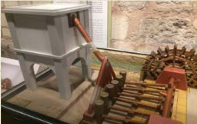
Takiyeddin'in M.1553'te ortaya koyduğu 6 Pistonlu Su Çıkarma ve Dağıtım Mekanizması
