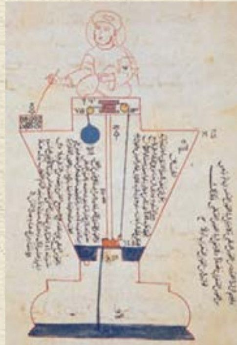
m.1200'lü yıllarda Diyarbakır' da yaşamış olan el Cezerî'nin kitabından alınan su doldurmak için Elektro-Pompa Su Saati (Çizim, el-Cezerîde, yazma İstanbul)
