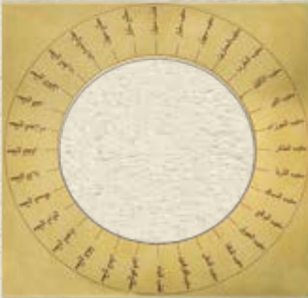
İbn-i Mâcid ve Süleymân el-Mehri'ye göre, Hint Okyanusu'ndaki Denizciye, seyir esnasında değişen yön açısını okuma imkanı sağlayan levha
