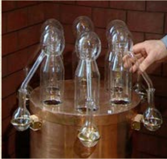
Zehrâvî (936-1013)'nin Kitâb et-Tasrif'indeki Gülyağı Distilasyon Aleti
