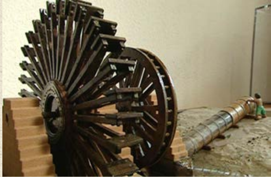
13. yüzyılda İslâm Dünyasında nehrin gücü kullanılarak yapılan Burgulu Pompa
