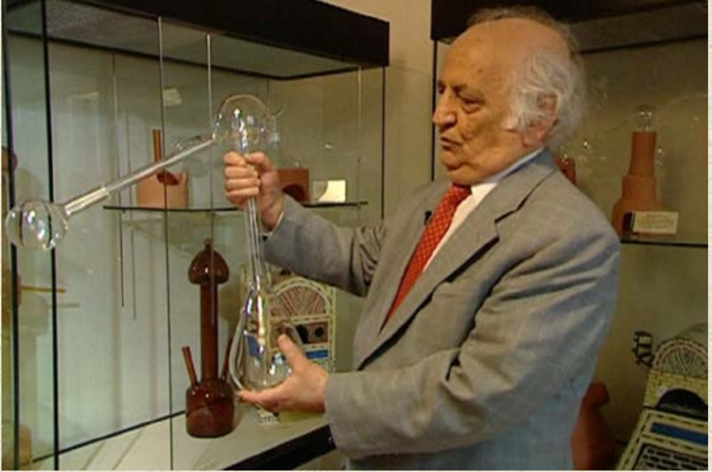
Fuat Sezgin Ebû Bekr er-Râzî'nin suların destilasyonu için tarif ettiği “Gagalı İmbik ve Damıtma Kabı” ile-2004
