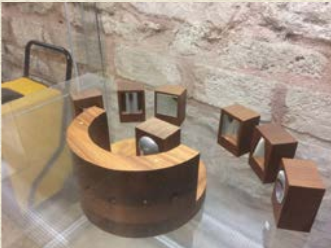
İbn-i Heysem'in 7 ayna kullanarak yaptığı Işığın yansımasını gözleme aleti
