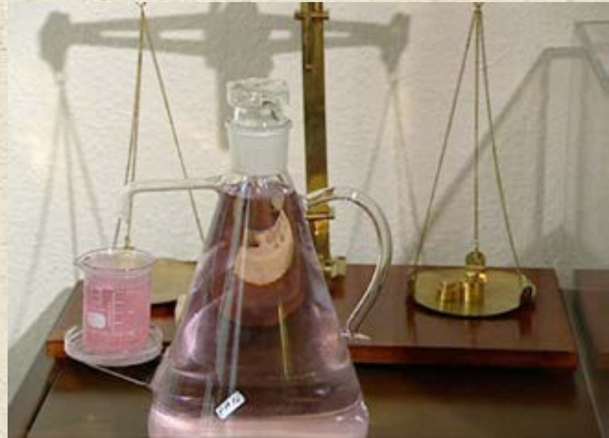
11. yüzyılda Birûnî tarafından yapılan katıların Özgül Ağırlıklarını Ölçme Aleti
