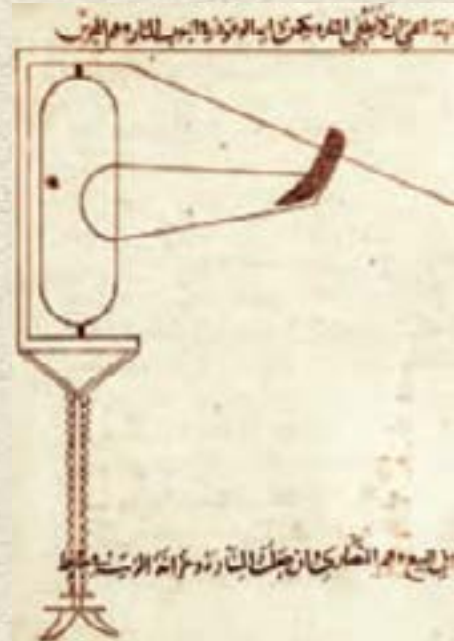
Benü Mûsâ'nın Kitabu'l-Hiyel inden 9. yüzyılda yapılan Şiddetli Rüzgârda Sönmeyen Lamba
