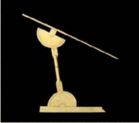
10. yüzyılda Ebû Sehl el-Kûhi (4./10. yüzyılın ikinci yarısı) Parabol, hiperbol ve elips yapma pergeli
